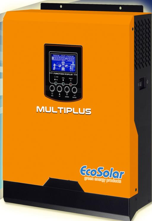
El multiequipo para instalaciones solares Multiplus 3Kva 24V 3000W DX de Ecosolar Green Energy Products incorpora en un mismo equipo un inversor de onda pura de 3000W de potencia nominales (6000W pico), un regulador solar de 50A, y un cargador de baterías de 20A.
