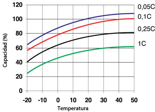
Fig. 1: Efectos de la temperatura en la capacidad
